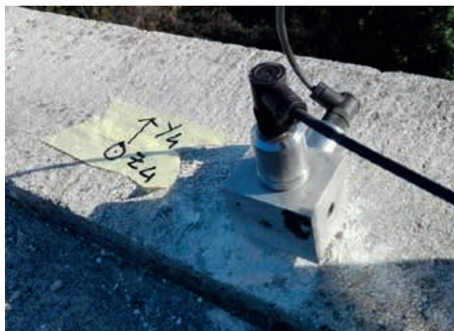
Figura 4 - Installazione degli accelerometri
